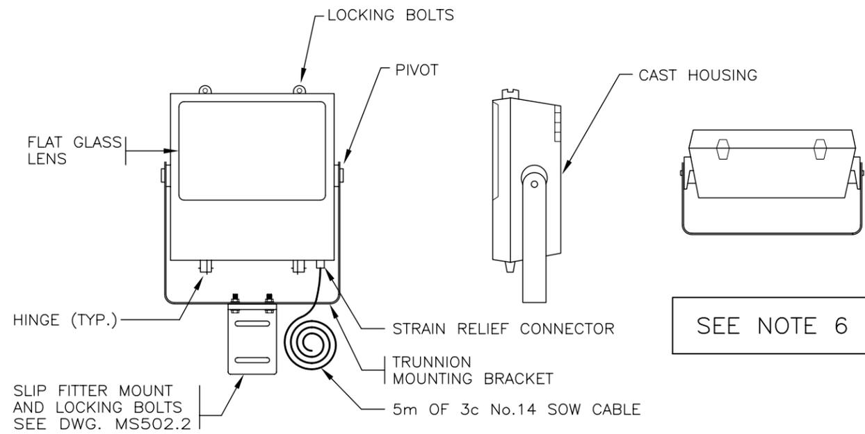
100W H.P.S. TYPE A SIGN LUMINAIRE (FLOOD LIGHT W/ FLAT LENS) (SN1784)
