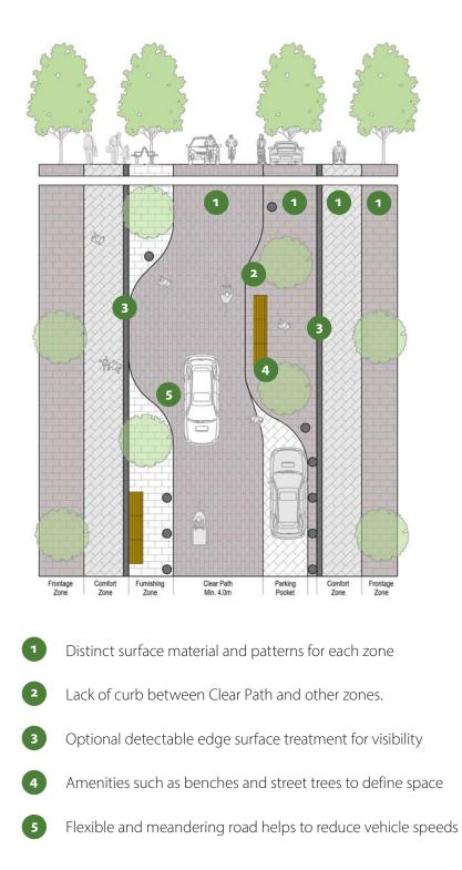
FIGURE E-64 // SHARED SPACE CONCEPTUAL LAYOUT AND KEY FEATURES
