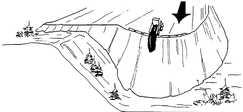
**FIG. 7.2 RECOMMENDED SEQUENCE FOR ADVANCEMENT OF DUMPS OVER STEEP TERRAIN**
