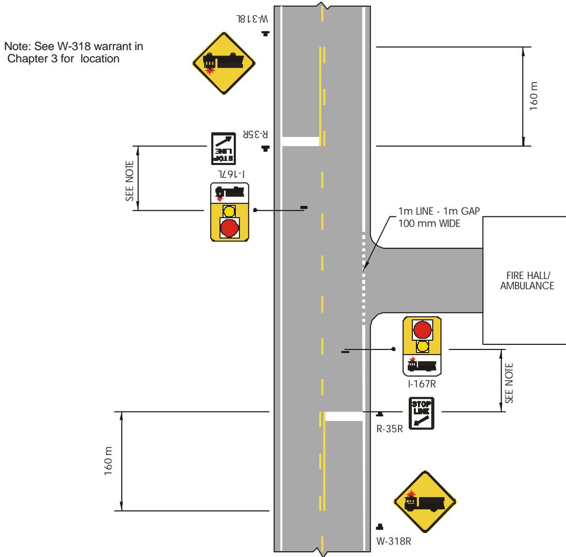
NOTE: THE MINIMUM DISTANCE FROM THE STOP BAR TO FIRE SIGNAL LIGHT IS 15 m. THE MAXIMUM DISTANCE IS 25 m. THE OPTIMUM DISTANCE IS 20 m.
